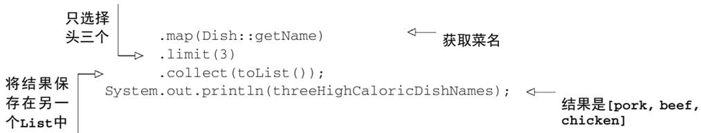
在本例中，我们先是对menu调用stream方法，由菜单得到一个流。数据源是菜肴列表（菜单），它给流提供一个元素序列。接下来，对流应用一系列数据处理操作：filter、map、limit和collect。除了collect之外，所有这些操作都会返回另一个流，这样它们就可以接成一条流水线，于是就可以看作对源的一个查询。最后，collect操作开始处理流水线，并返回结果（它和别的操作不一样，因为它返回的不是流，在这里是一个List）。在调用collect之前，没有任何结果产生，实际上根本就没有从menu里选择元素。你可以这么理解：链中的方法调用都在排队等待，直到调用collect。图4-2显示了流操作的顺序：filter、map、limit、collect，每个操作简介如下。
