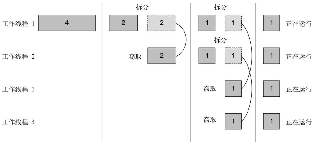
图7-5 分支/合并框架使用的工作窃取算法
