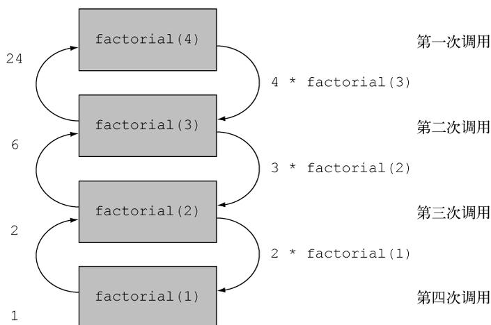
图13-5 使用栈帧方式的阶乘的递归定义
