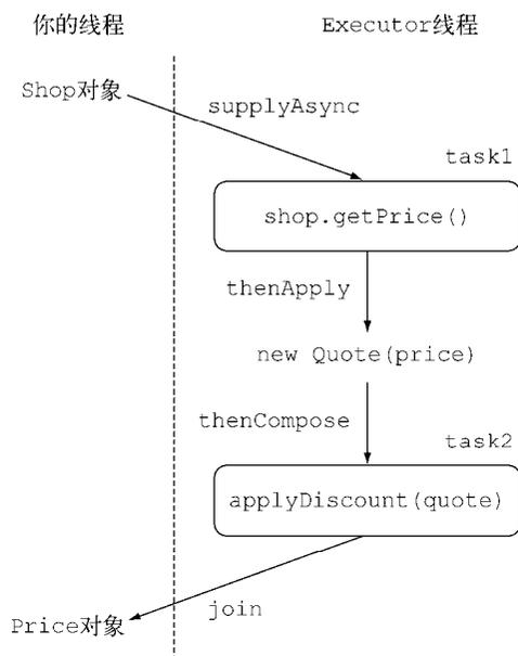
图11-5 构造同步操作和异步任务
